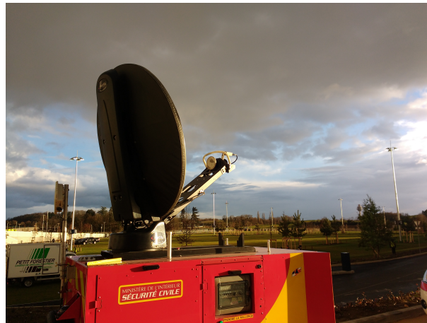
Figure 2.3: Image d'une parabole mobile déployée lors d'un exercice de secours. Couplée à un groupe électrogène, elle permet un accès à Internet et une coordination des services, même en l'absence de toute infrastructure. Source : lafibre.info
